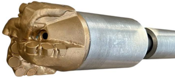
Рисунок 4 – PDC-долото діаметром 92 мм, використане для стендового буріння гранітних зразків
