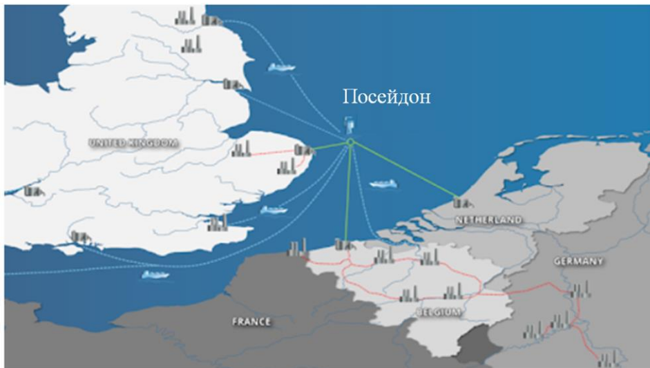
Рисунок 3 – Схема подавання CO 2 до виснаженого газового родовища Leman (проект Poseidon) [60]
