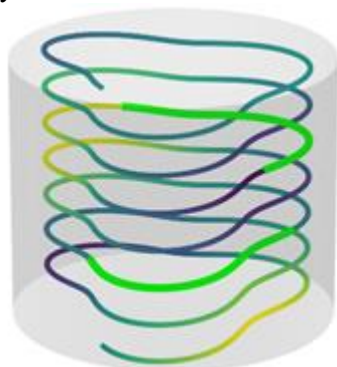
Рисунок 7 – 3D скінченно-елементна візуалізація преміум-з'єднання VAM TOP з додатковою системою ущільнення
