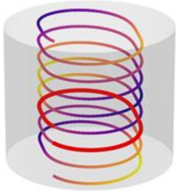
Рисунок 5 – 3D-модель різьби типу ОТТГ з виділеними зонами ущільнення
