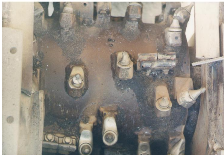
Рисунок 6 – Барабан дорожньої фрези із різцями в різному ступені зношування: повна втрата твердосплавного наконечника у частини різців
