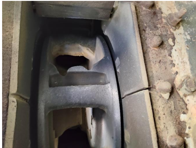
Рисунок 2 – Загальний вигляд зношеного ротора дробарки Pulvomatic
