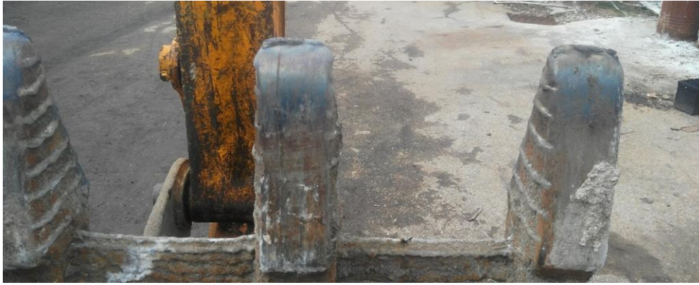
Рисунок 1 – Загальний вигляд зношених зубів кар’єрного екскаватора JCB
