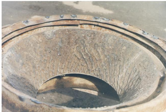
Рисунок 4 – Робоча поверхня конусної дробарки після реставрації методом наплавлення
