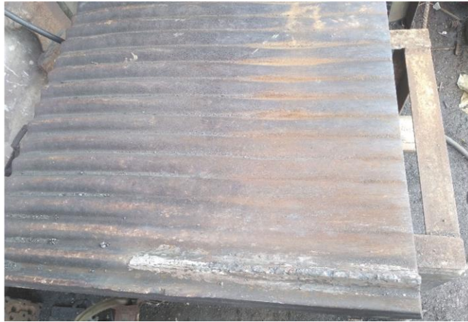
Рисунок 5 – Плита щоквої дробарки із нерівномірним зносом.
