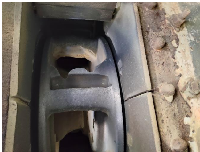
Рисунок 2 – Загальний вигляд зношеного ротора дробарки Pulvomatic
