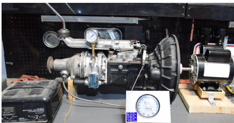
1 – блок живлення; 2 – давач частоти обертання вихідного вала коробки перемикавання передач; 3 – контрольний манометр; 4 – контрольно-вимірювальний блок із ватметром та тахометром; 5 – термомпара; 6 – коробка перемикавання передач агрегату; 7 – електродвигун
