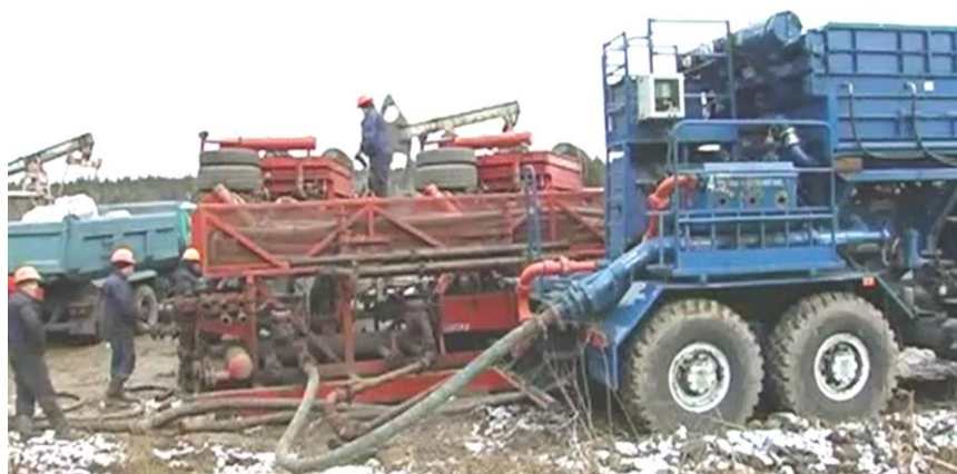
Рисунок 4 – Проведення промислових випробувань на базі мобільного агрегату для гідравлічного розриву пластів мод. FC-2251
