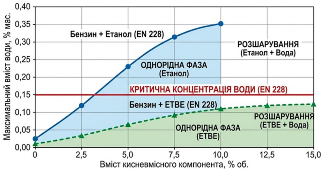
Рисунок 3 – Графік залежності максимальної вологоємності від вмісту кисневмісних компонентів та межі фазової стабільності згідно з EN 228
