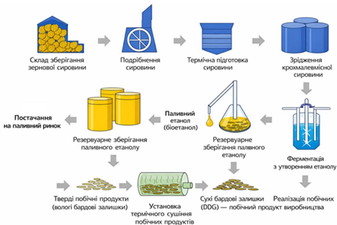
Рисунок 1 – Схема виробництва біоетанолу та формування його експлуатаційно значущих властивостей у паливній інфраструктурі
