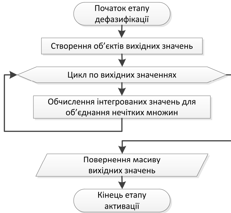
Рисунок 4 – Блок-схема етапу дефазифікації
