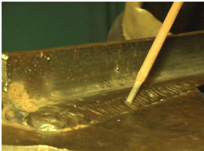
Рисунок 5 – Дефект зварного шва (кратер)
