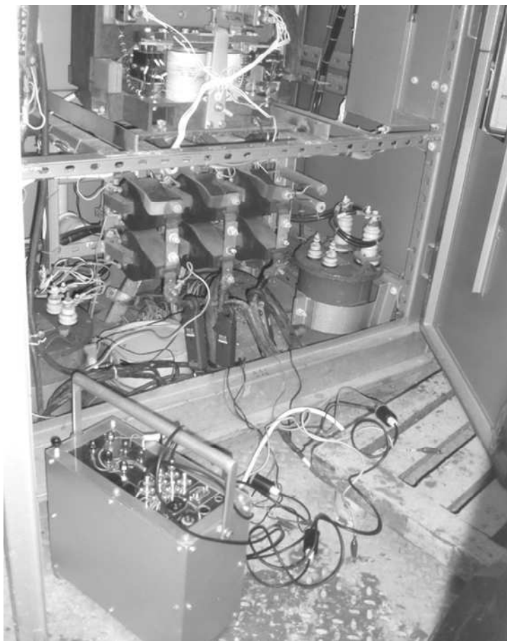
Рисунок 11 – Шафа електробура і прилад для збору енергетичних параметрів ЕЛБ
