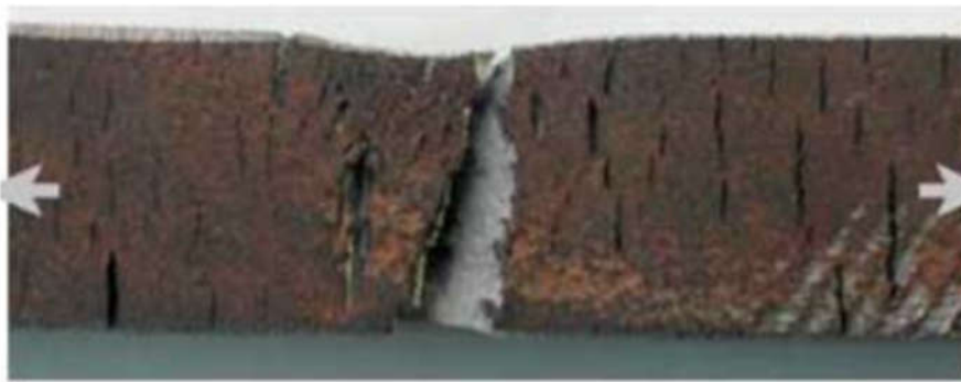
Рисунок 4 – Взірець з окрихченням сталі після випробування на розтяг
