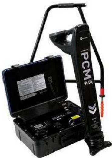
Рисунок 14 – Загальний вигляд системи контролю ізоляційного покриття PCM Plus, робота якої базується на амплітудному методі контролю (фірма Radiodetection)
