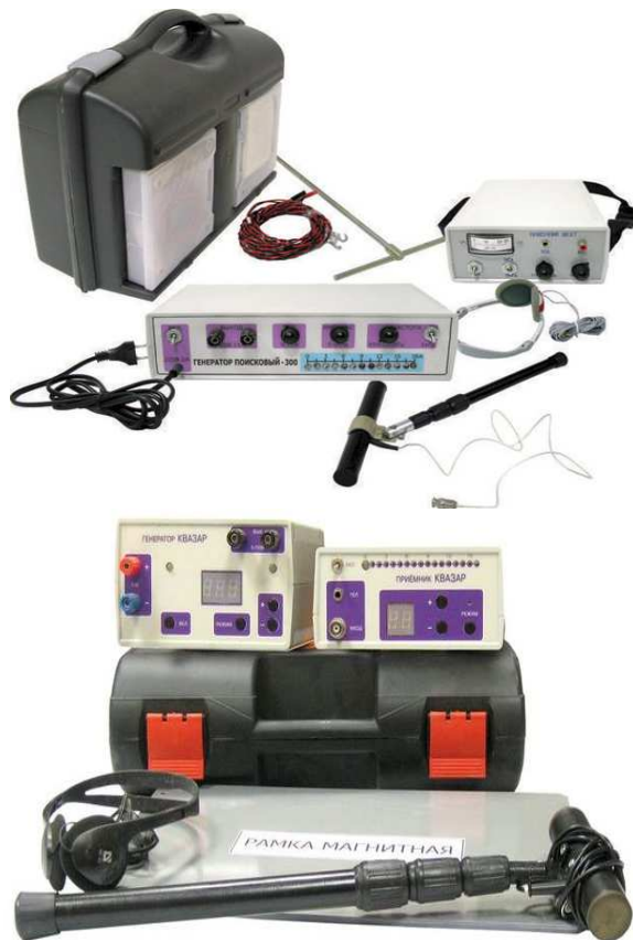
а) – трасошукач «ИКкт-300»; б) – шукач пошкоджень «Квазар»
