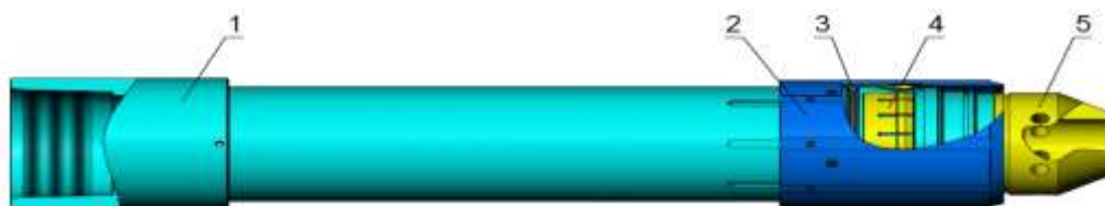
1 – муфта приєднувальна, 2 – захисний кожух, 3 – ущільнення, 4 – цанга, 5 – направляючий башмак
