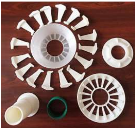
Рисунок 7 – Виготовлення моделі вставки ущільнювача універсального превентора
