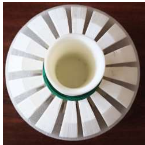
Рисунок 7 – Виготовлення моделі вставки ущільнювача універсального превентора
