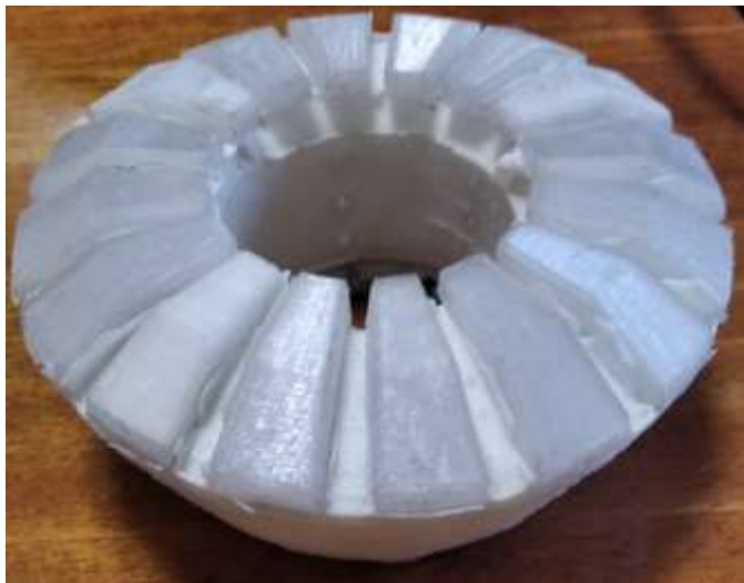
Рисунок 9 – Виготовлена модель ущільнювача превентора
