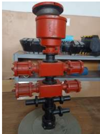
Рисунок 10 – Установка для дослідження конструкції моделей ущільнювачів універсальних превенторів
