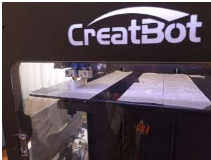
Рисунок 7 – Виготовлення моделі вставки ущільнювача універсального превентора
