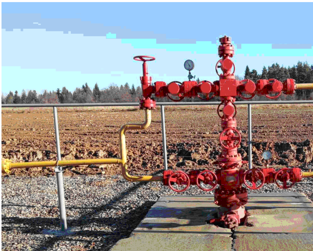
Рисунок 2 – Варіант облаштування буферного фланця ФА гайкою швидкого з'єднання
