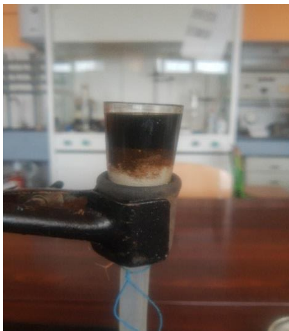
Рисунок 3 – Випробувальний зразок, наповнений нафтою
