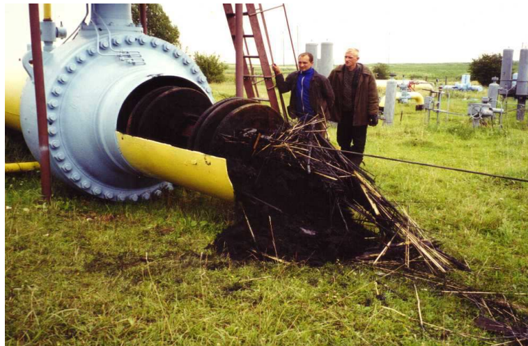
Рисунок 8 – Типи поршнів для очищення внутрішньої порожнини магістральних газопроводів
