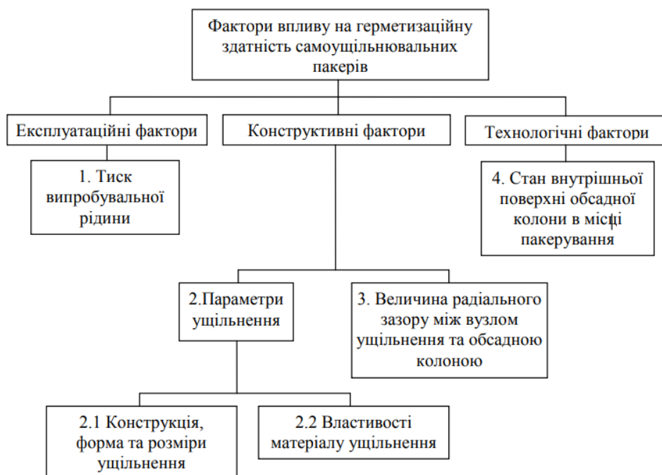
Рисунок 1 – Структурна схема чинників впливу на герметизаційну здатність самоущільнювальних випробувальних пакерів
