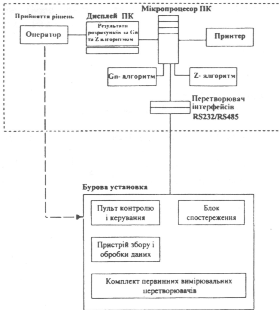
Рисунок 2 – Функціональна схема пристрою визначення зміни меж пластів
