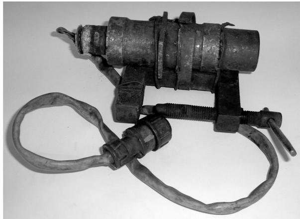
**Рисунок 1 — Штатный акселерометр МП-95 МИИСК**
