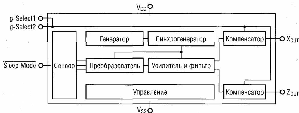
Рисунок 5 — Функциональная схема акселерометра MMA6280Q фирмы Freesal Semiconductor
