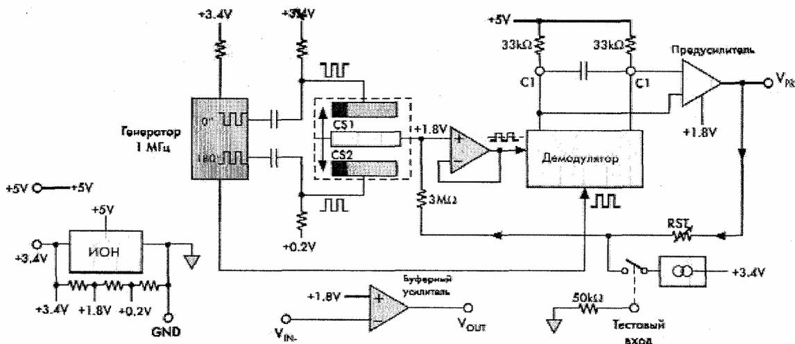
Рисунок 2 — Функциональная схема семейства акселерометров ADXLxxx
