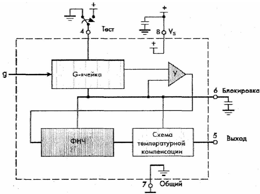
Рисунок 4 — Функциональная схема акселерометра семейства ХММА фирмы Motorola
