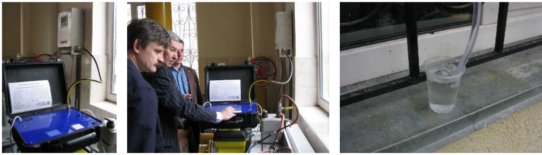
Рисунок 6 – Процес проведення промислової апробації дослідного взірця приладу для експрес-контролю теплоти згоряння природного газу на базі лабораторії перевірки промислових лічильників газу на природному газі ПАТ «Івано-Франківськгаз»
