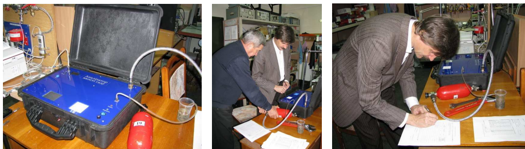
Рисунок 4 – Процес визначення теплоти згоряння природного газу за допомогою дослідного взірця приладу в науково-дослідній лабораторії кафедри енергетичного менеджменту і технічної діагностики ІФНТУНГ
