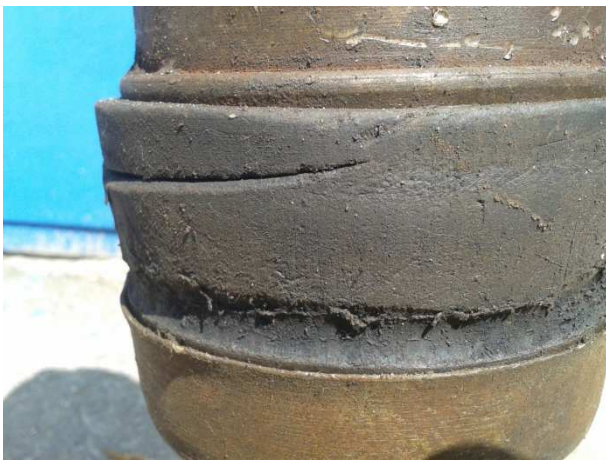
Рисунок 3 – Приклад руйнування опорної частини самоущільнюючої манжети внаслідок видавлювання гуми в зазор між упором та обсадною трубою
