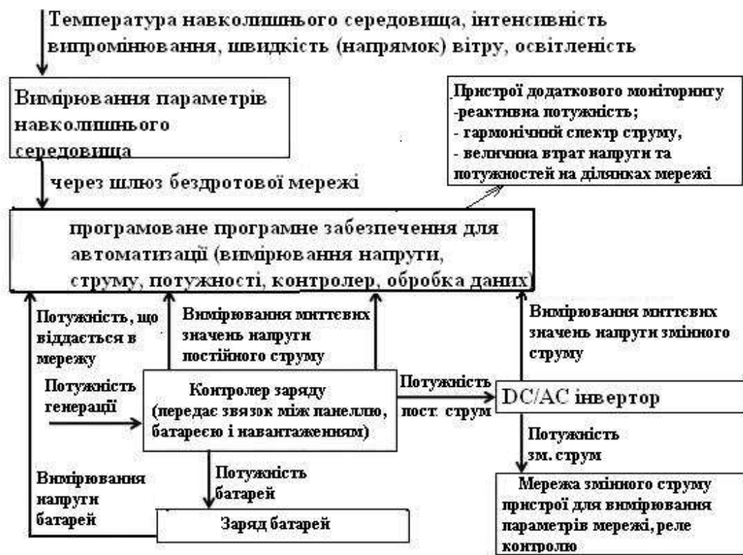
Рисунок 2 – Блок-схема типової системи сонячної моніторингу
