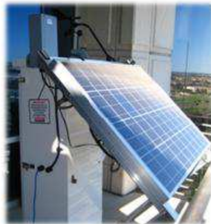
Рисунок 5 – Система обліку параметрів генерації сонячної електростанції
