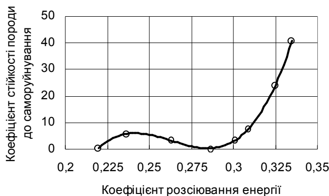
Рисунок 3 – Залежність коефіцієнта стійкості породи до саморуйнування від коефіцієнта розсіювання енергії
