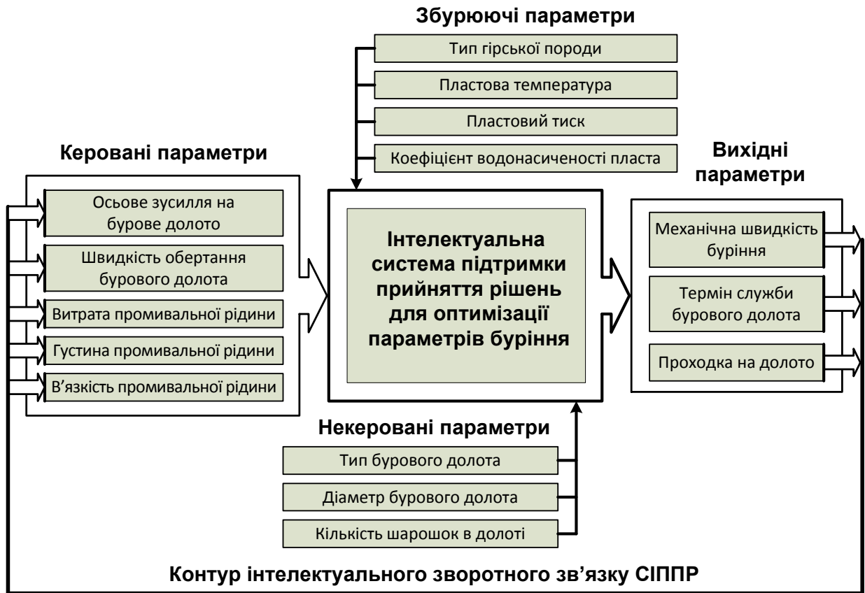
Рисунок 6 – Структура інтелектуального зворотного зв'язку в системі інтелектуальної підтримки прийняття рішень
