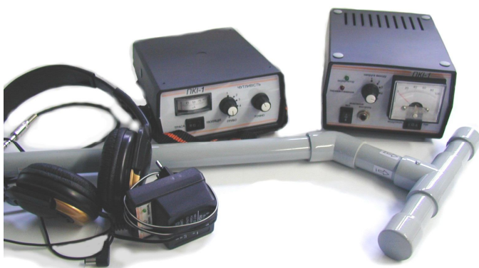
Рисунок 3 – Пристрій контролю ізоляції ПКІ-1
