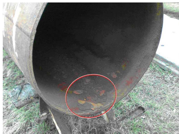
Рисунок 1 – Утворення корозії під композицією «вода-тверді відклади» на дні трубопроводу в місцях утворення газоконденсатної пробки
