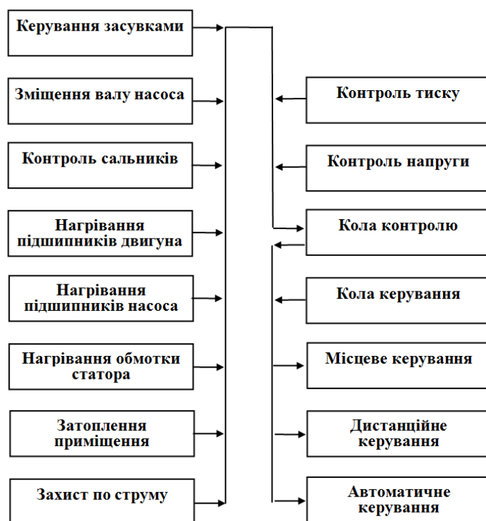
Рисунок 1 – Структурна схема уніфікованого блоку місцевої автоматики БМА-19
