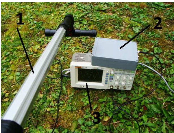
1 – магнітна антена; 2 – вимірювальний блок; 3 – цифровий двоканальний осцилограф
