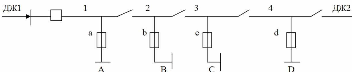
Рисунок 4 – Схема мережі із захистом за допомогою запобіжників
