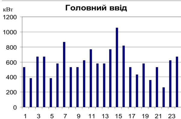
Рисунок 2 – Добовий графік активного навантаження бурового верстата
