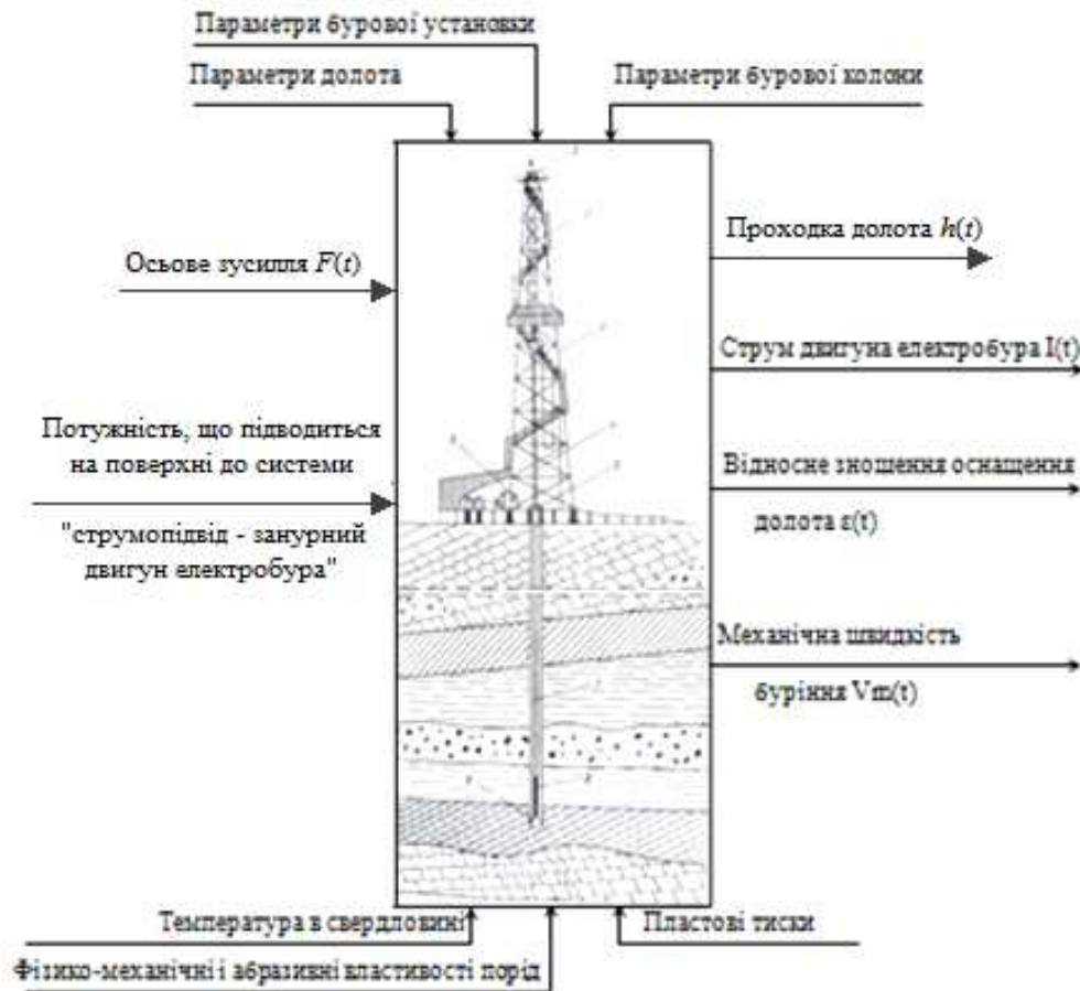
Рисунок 1 – Структурна схема процесу буріння свердловин електробуром
