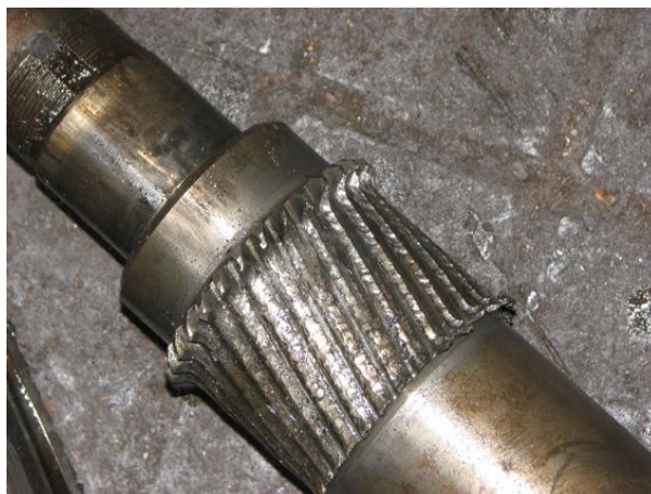
Рисунок 1 – Типові поломки зубчастих передач редуктора верстата-гойдалки
