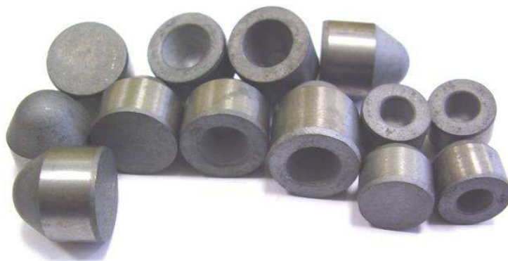
Рисунок 2 – Загальний вигляд серійних і експериментальних (з пустотілим хвостовиком) твердосплавних зубків
