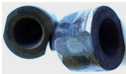
Рисунок 3 – Загальний вигляд експериментального твердосплавного зубка, підданого металографічним випробуванням
