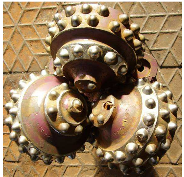
Рисунок 5 – Загальний вигляд оснащення тришарошкового бурового долота 250,8 ТКЗ – ПГВ – Д27Б з експериментальними зубками, що відпрацьовувало в стендових умовах 30 годин
